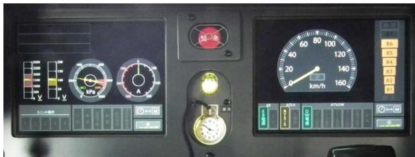
図6 227系、及び323系電車の運転台パネル
