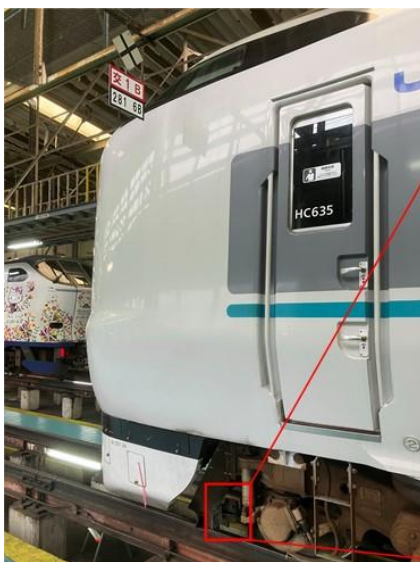
排障器の設置場所
