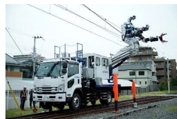
▲多機能鉄道重機
