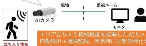
エリア立ち入り検知機能を搭載した AI カメラにより、自動検出 + 遠隔監視、異常時には緊急停止を促す
