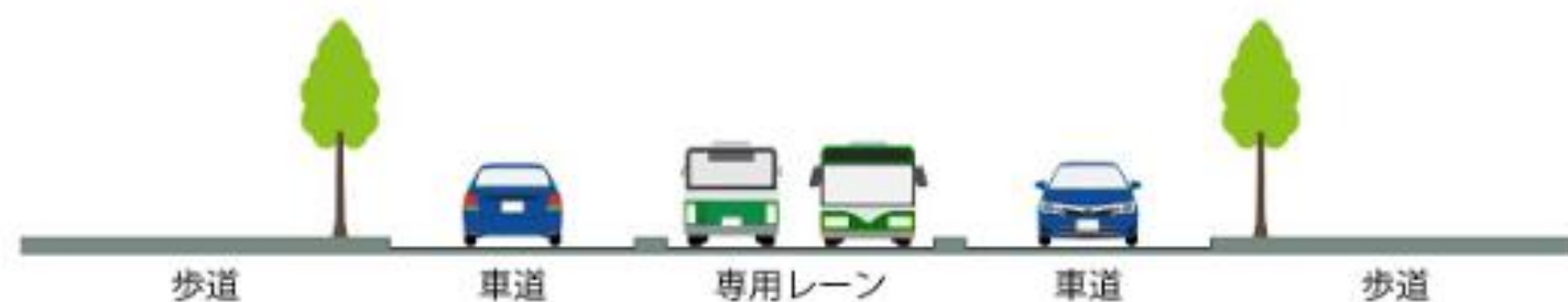
▲バス専用レーン設置（BRT運行）案の断面イメージ （道路中央側に専用レーンとした場合）
