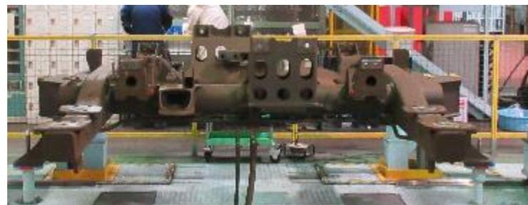
〈参考〉 事象発生後、全ての台車枠の超音波探傷を実施し、傷の疑いのあるエコー反応を示した台車枠は2019年2月までに全て取替えました。
