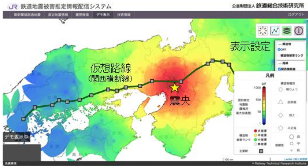
図2 本システムによる面的な揺れの表示例
