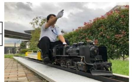
▲本物の SL と同じ仕組みで動くミニ SL がけん引する客車に乗車できます。
