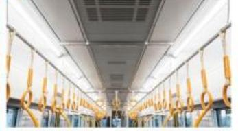
車内照明はLED照明を使用します。天井からの間接光を組み合わせることにより柔らかい光となり、落ち着いた車内空間となります。
