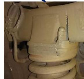
台車枠の一部に亀裂
