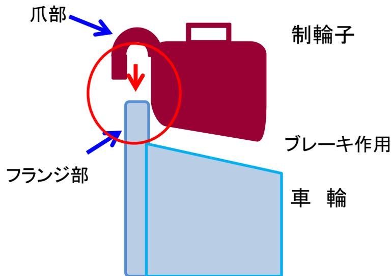
ブレーキ作用により制輪子が車輪に押し付けられ、同時に制輪子爪部が車輪フランジ部に嵌り込む
