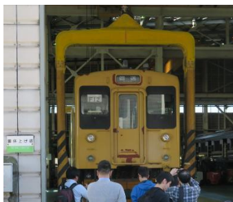
※大型クレーンによる車両の空中移動 (イメージ)
