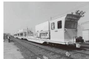
逸脱防止ガード敷設連搬車
