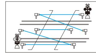
○平面LiDARセンサ式障害物検知装置
