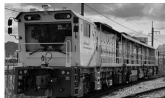
レール削正車(在来線用)LRR16
