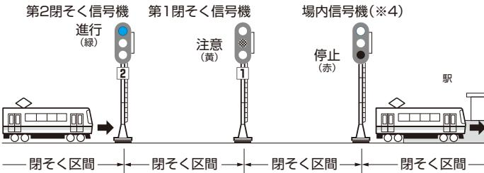
※1) 軌道回路…線路の左右のレールに弱小な電気を流し、電気の回路を構成しています。この回路のことを軌道回路といいます。
