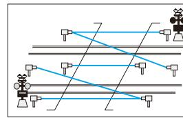
○ 平面LiDARセンサ式障害物検知装置
