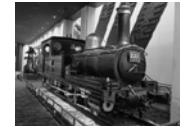
神通省鉄道作業局が汽車製造合資会社に発注して1903年度に竣工しました。我が国で初めて量産化された蒸気機関車で、海外から輸入した蒸気機関車と比べてもそんぞんない性能を発揮し、その成功が日本の蒸気機関車国産化の原点となりました。我が国機関車製造の自立にとって大きな転換点となり、近代化に大きく貢献した鉄道史、産業史上、貴重なものです。
