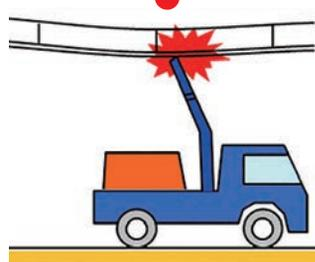
最大25,000Vの電気が流れており、ブームなどが電線に近づくだけで感電する可能性があります。
