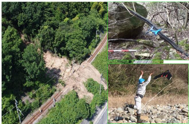
直接の目視確認が困難な用地外や急斜面の発生源もドローンで安全に現況確認
