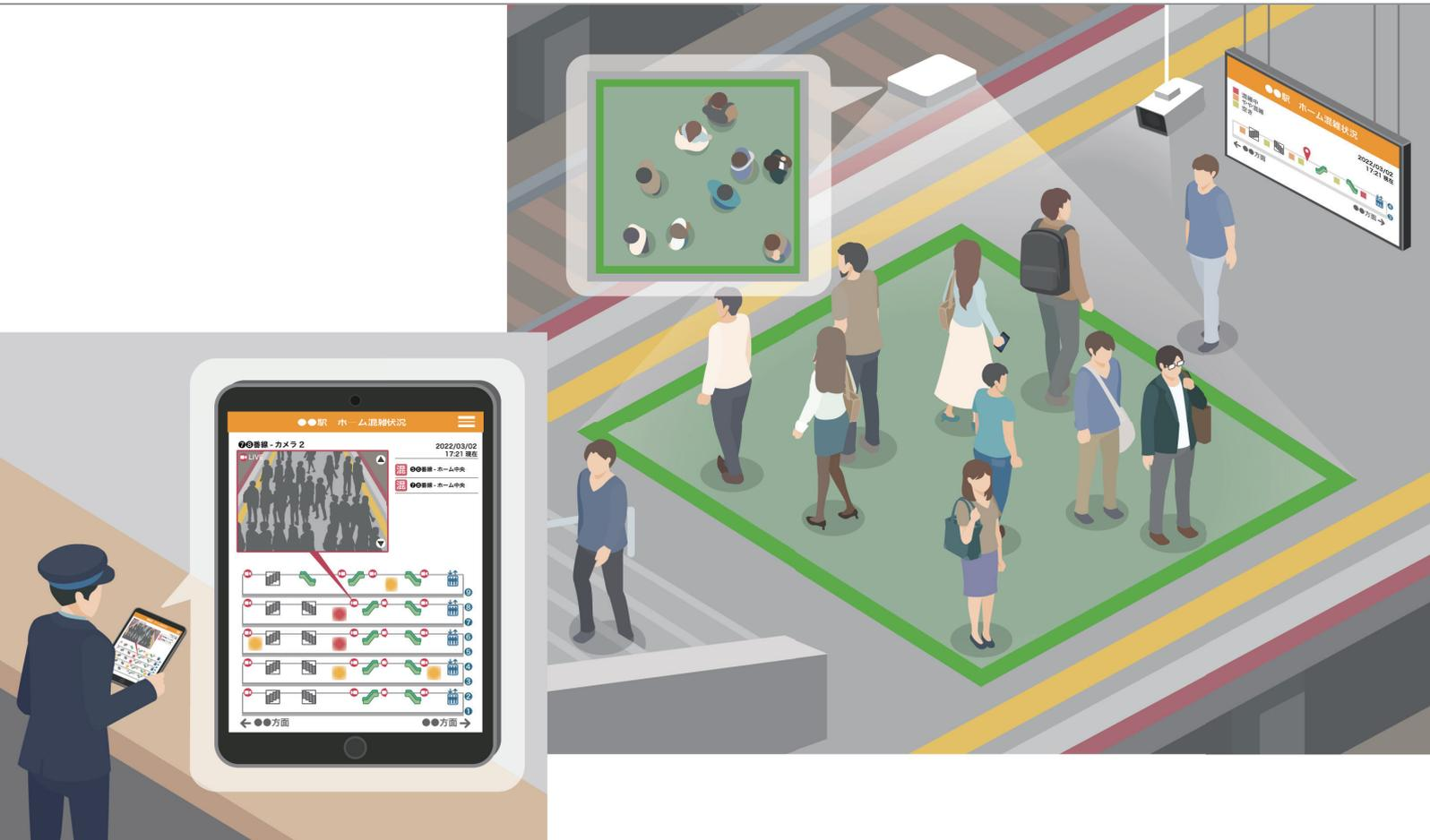
センサにより人の滞留をカウントし、混雑状況をデータ化することができます。
