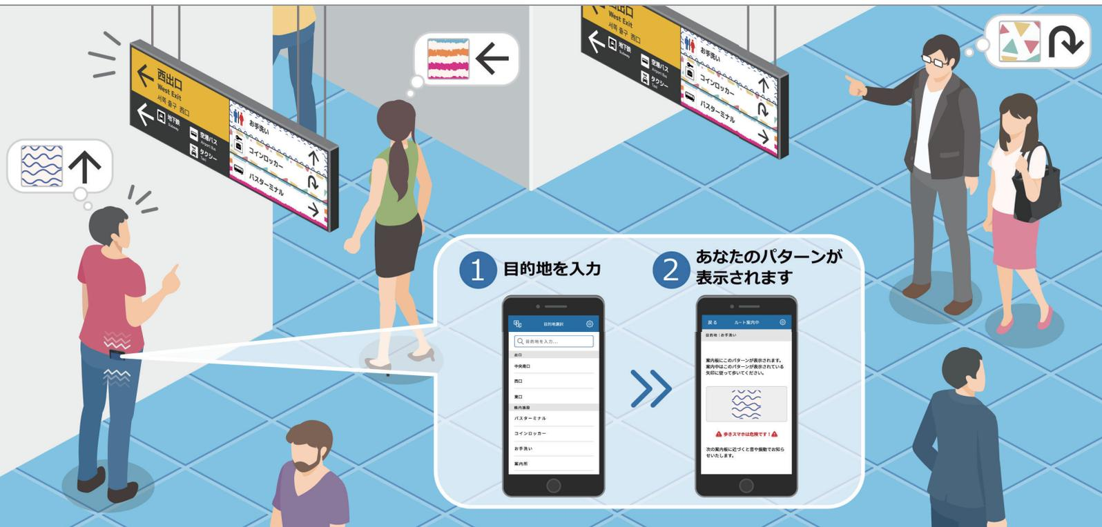
モバイルアプリに目的地を設定したユーザがディスプレイに接近すると、ユーザデバイス(スマートフォン)がディスプレイ近傍に設置されたビーコンの電波を受信し、ディスプレイにユーザの設定した目的地への案内が表示されます。広告表示や異常時の案内に活用することも可能です。
