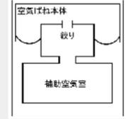
図5：空気ばね模式図
