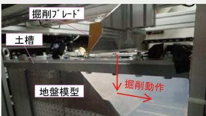
図2：遠心模型実験装置
