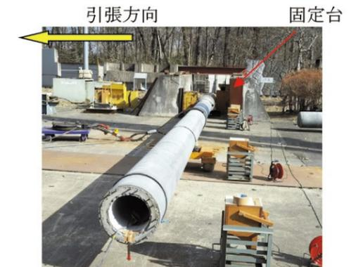
図7: 曲げ性能試験
