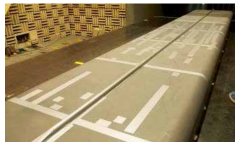
写真3：新幹線屋根模型
