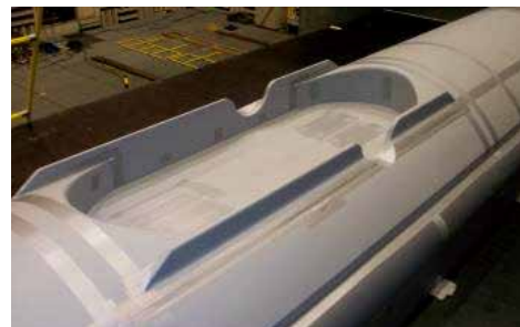
写真4：FGT屋根模型(パンタ搭載部)
