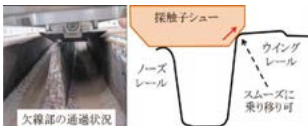
図7：クロッシング欠線部の通過状況(断面図)
