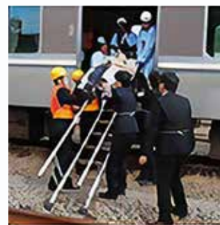
手すり付梯子
