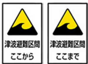
浸水区間 起点・終点標
