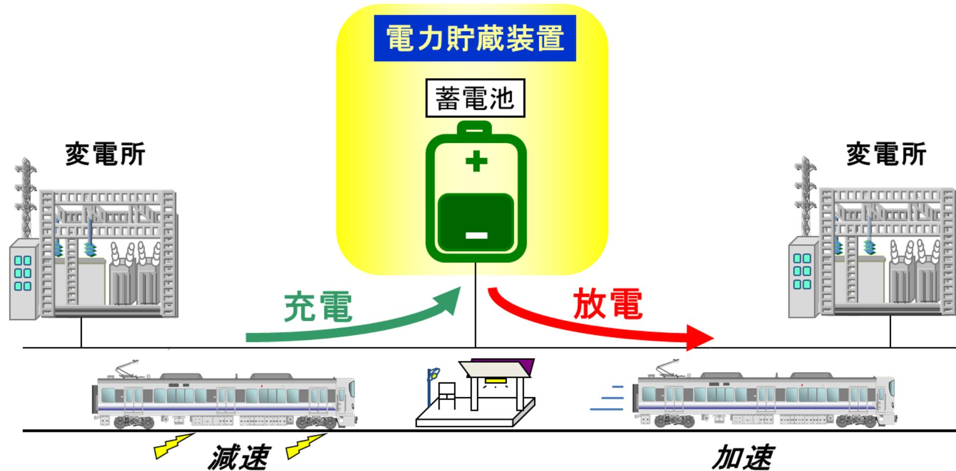
列車がブレーキをかけた時に発生した回生電力を一旦、電力貯蔵装置に蓄電し、加速する列車に給電するシステム
