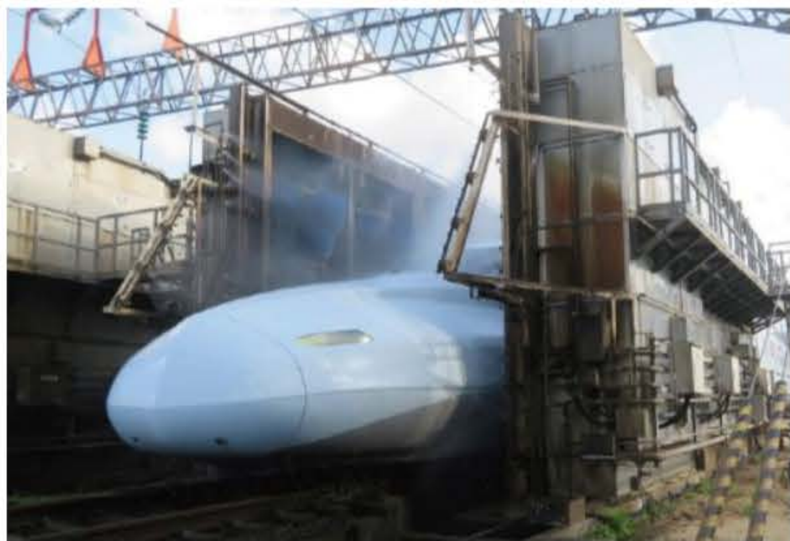
工場排水の再利用による車両洗浄機（新幹線）
