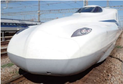
省エネルギー型車両のN700S新幹線車両
