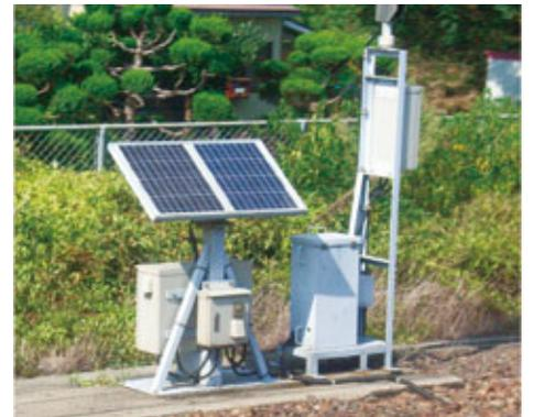
太陽電池を電源に用いた電動塗油器
