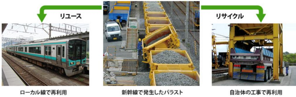
新幹線で使用されたレールやバラストの一部は、社内のリサイクル施設で在来線の基準を満たすように整備したうえで再利用しています。また、再利用できないバラストについては、破碎や選別を行い再生砕石【注釈1】、再生骨材【注釈2】、再生路盤材【注釈3】にするなどリサイクルしています。
