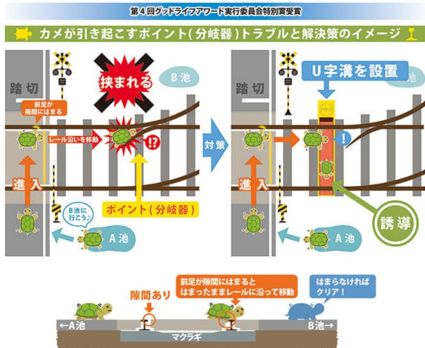
和歌山線JR五位堂駅にある線路の分岐器に外来種のカメが挟まり動作しないことによる列車遅延が、これまでしばしば発生していました。そこで須磨海浜水族園からカメの習性に関する知見を得て、「カメ救出装置（アニマルパスウェイ）」を設置した結果、2015年の夏にカメ10匹を捕獲し、輸送障害削減と付近の池の生態系保全に寄与しました。
