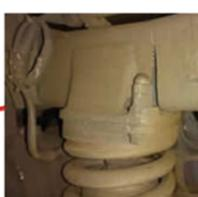
台車枠の一部に亀裂
