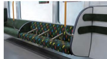
立ち上がり動作の補助となる肘掛を設置したシートと、全車両に車いす・ベビーカースペースを設置
