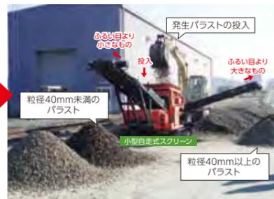
バラストのふるい分け(自走可能な装置でバラストの輸送ロスを低減)
