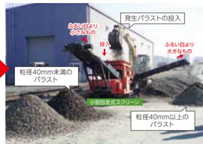
バラストのふるい分け(自走可能な装置でバラストの輸送ロスを低減)
