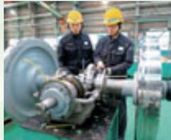
車両は、摩耗した部品の取り替えや機能確認などの日々の点検・整備のみならず、機器を取り外しての綿密な検査を定期的を実施し、安全に運転できる状態を維持しています。
