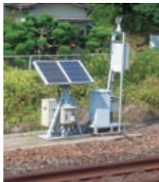
太陽電池を電源に用いた電動塗油器
