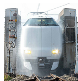
車両基地での車体洗浄
