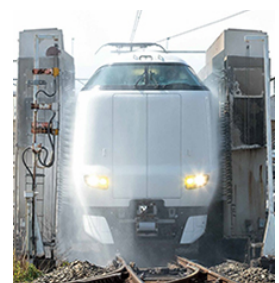
車両基地での車体洗浄
