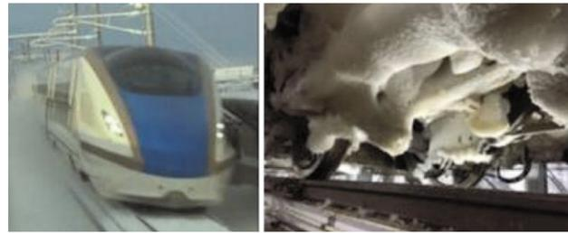
図1：北陸新幹線車両への着雪の様子
