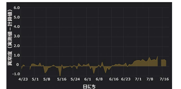
図7：健全な空調装置の異常度の推移例
