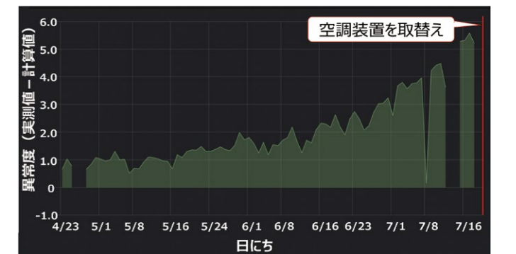
図6：故障した空調装置の異常度の推移例
