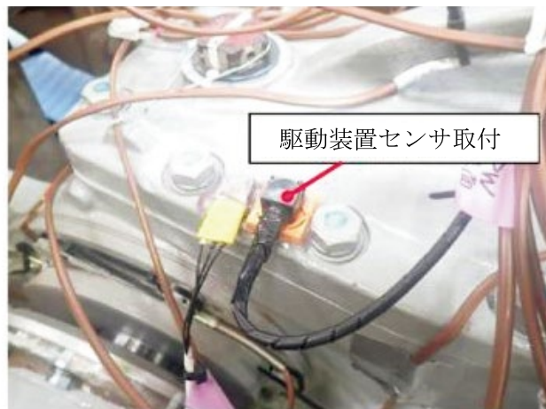
図5：駆動装置への仮設状況(振動加速度)
