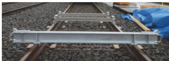
写真1：車体仮受治具
