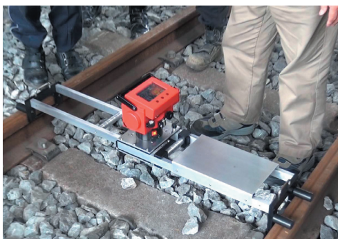
写真2：簡易型建築限界測定器
