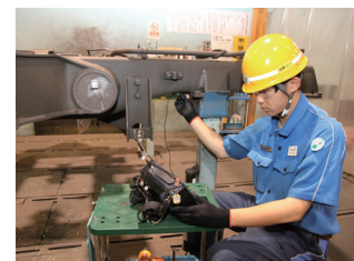
超音波探傷状況
