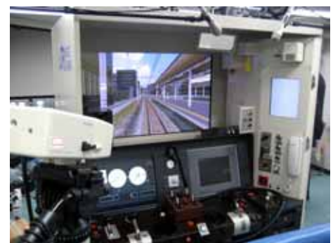
図9 在来線運転訓練用シミュレータ
