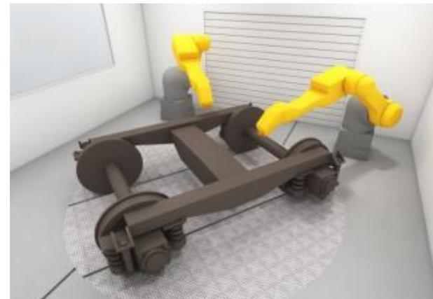
ロボットによる自動塗装
