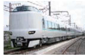
特急「くろしお」(287系) 代表的編成 6両 定員 360人 最高速度 130km/h
