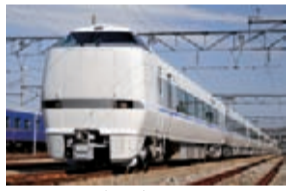
特急「サンダーバード」(683系) 代表的編成 9両 定員 546人 最高速度 130km/h
