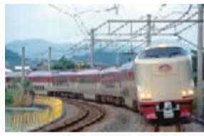
サンライズ出雲 (285系) 代表的編成 7両 定員 150人 最高速度 130km/h
