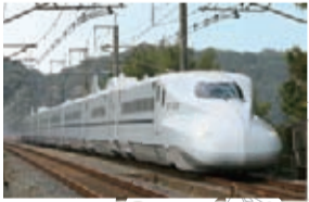
新幹線「たけがき」(みずほ) N700系 (5編成) 代表的編成 8両 定員 546人 最高速度 300km/h
