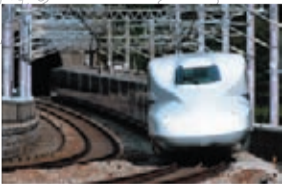
新幹線「のぞみ」N700系 (N編成) 代表的編成 16両 定員 1,323人 最高速度 300km/h
