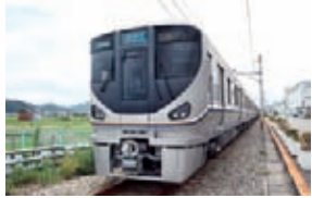
225系新快速 代表的編成 8両 定員 1,091人 最高速度 130km/h
