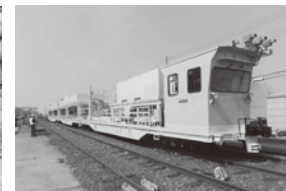
逸脱防止ガード敷設運搬車
