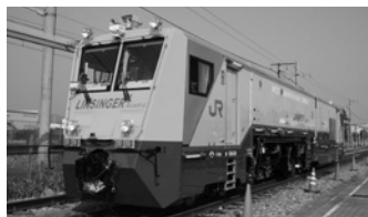
レール削正車(在来線用)SF01T-F
