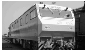
超音波レール探傷車MS-0190
