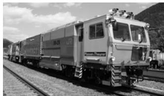
マルチブルタイタンバ(新幹線用)08-2X
